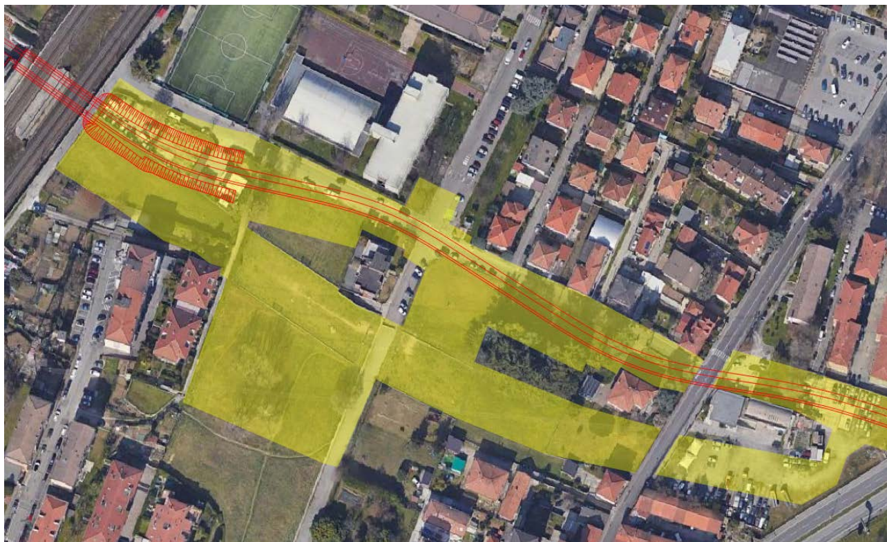
Figura 2.2 - Tracciato di progetto (in rosso) e aree di cantiere (in giallo) nell'ambito del quartiere S. Alessandro a Monza.
