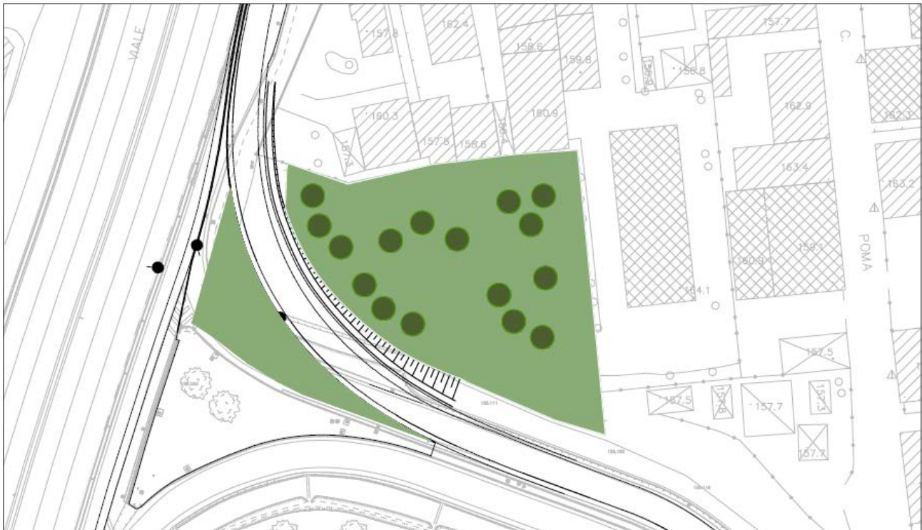
Figura 4.5 – Assetto vegetazionale previsto per la riqualificazione dell'area degradata a lato rampa di uscita sulla SS36.
