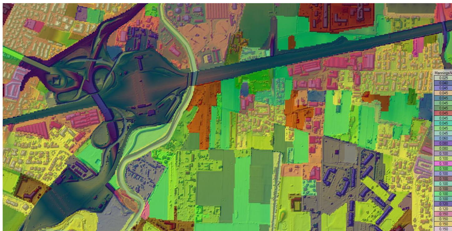
Figura 6.13: Coefficienti di Manning utilizzati nell'area esaminata sovrapposti a modello digitale del terreno.
