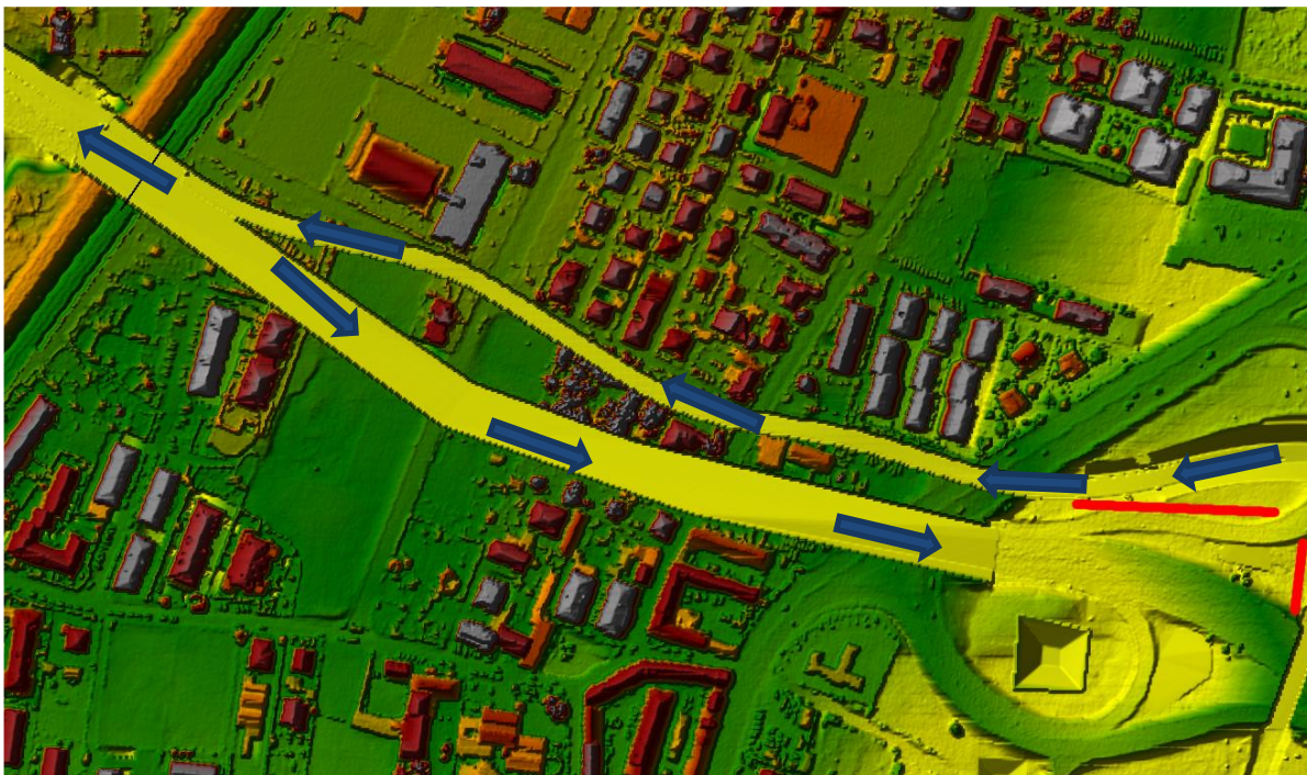
Figura 6.37: Modifica della dinamica di propagazione delle esondazioni nel caso di inserimento degli argini. Con frecce blu la direzione del flusso.
