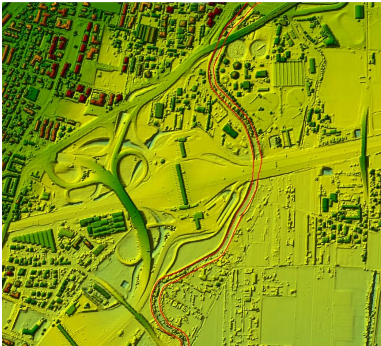
Figura 6.2: Dati 3D del lidar DSM Last. In rosso l'alveo del Lambro.
