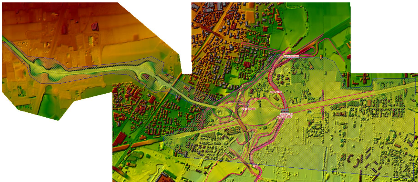
Figura 6.9: L'area 2D inserita nel modello idraulico.
