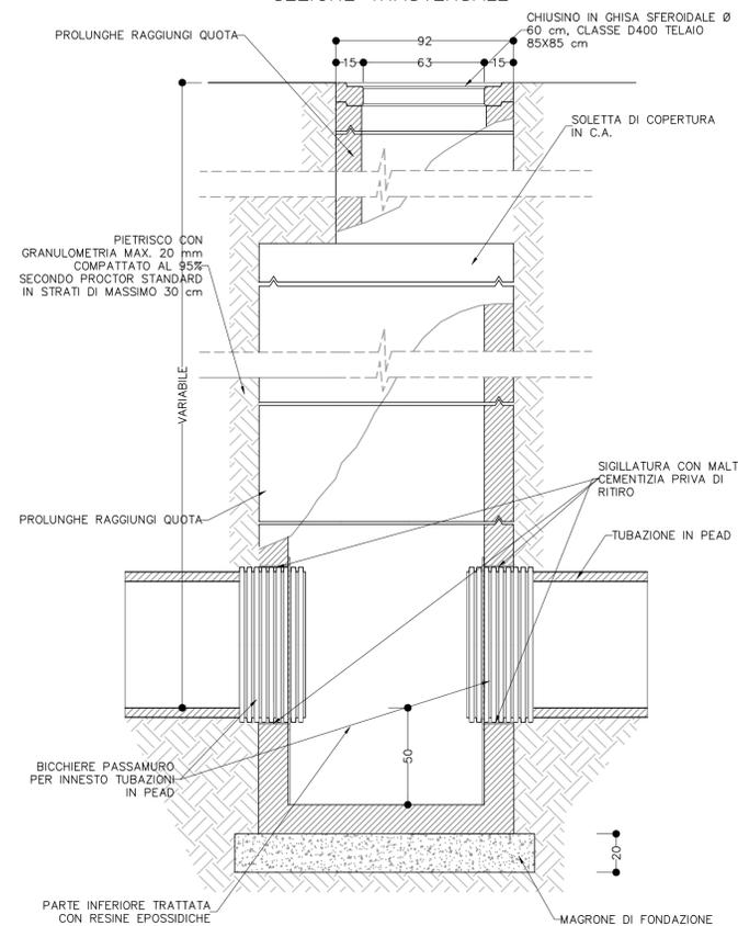
**PARTICOLARE POZZETTO DI CAMPIONAMENTO**
