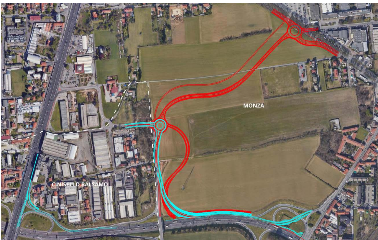
Figura 1.3 – Confronto tra versione progettuale sottoposta a procedura di Verifica VIA (in rosso) e attuale proposta progettuale (in azzurro), con evidenza delle parti eliminate rispetto alla prima versione oggi superata
