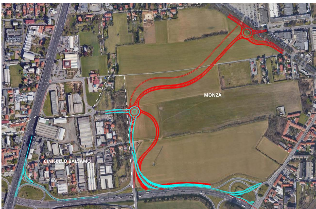
Figura 2.1 – Confronto tra versione progettuale sottoposta a procedura di Verifica VIA (in rosso) e attuale proposta progettuale (in azzurro), con evidenza delle parti eliminate rispetto alla prima versione oggi superata
