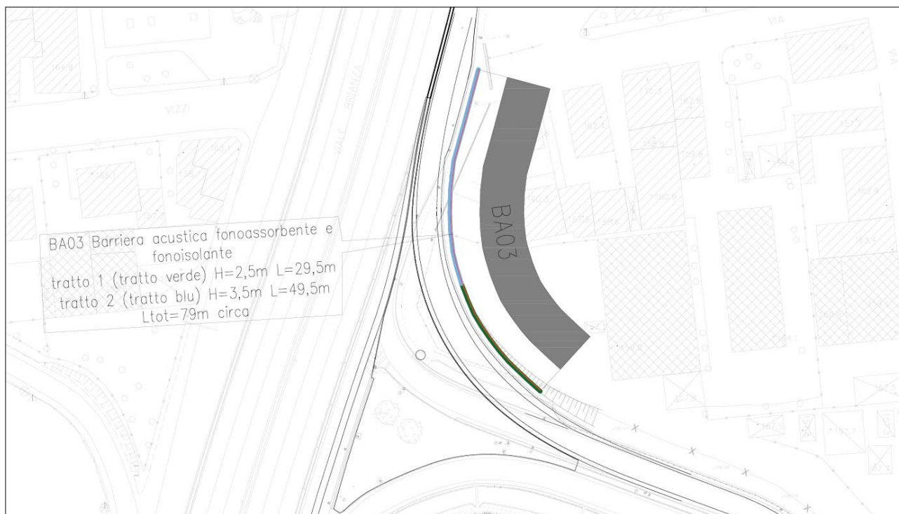
Figura 4.22 – Misura di mitigazione acustica nell'area dello svincolo SS36.
