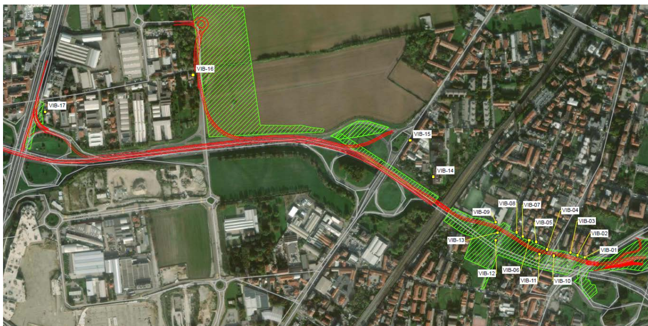
Figura 4.28 – Ricettori antropici in corrispondenza dei quali saranno attuati controlli dei disturbi sensoriali e degli eventuali danneggiamenti degli edifici potenzialmente indotti dalle vibrazioni di cantiere e generate dal traffico circolante in fase di esercizio dell'opera di progetto.
