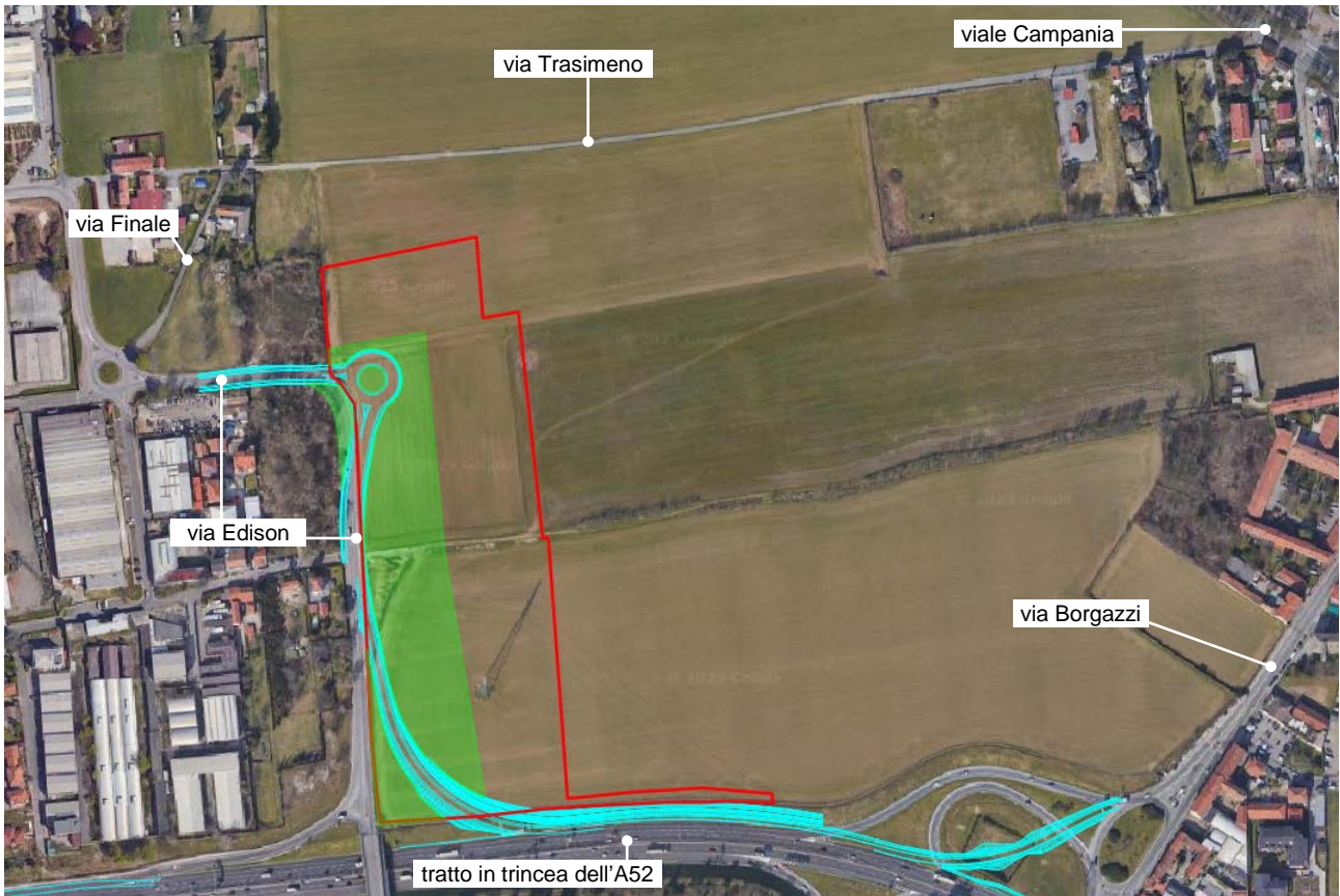
Figura 2.4 – Perimetro (in rosso) delle aree di prevista occupazione dei cantieri funzionali alla realizzazione del tratto stradale di collegamento con via Edison (in azzurro) nell'area del Casignolo e superfici destinate dal progetto a nuovi ecosistemi vegetazionali permanenti
