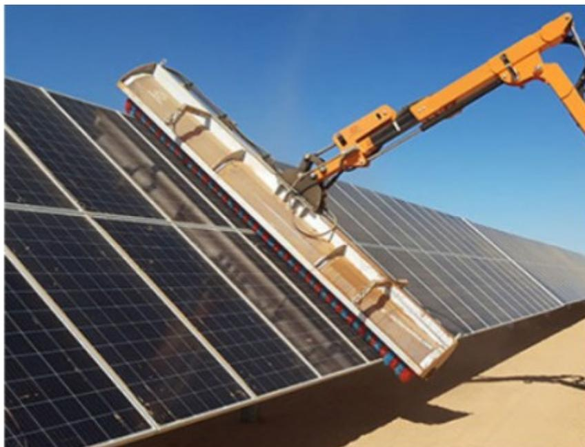
*Figura 1: Esempio del braccio telescopico e della spazzola in azione.*
