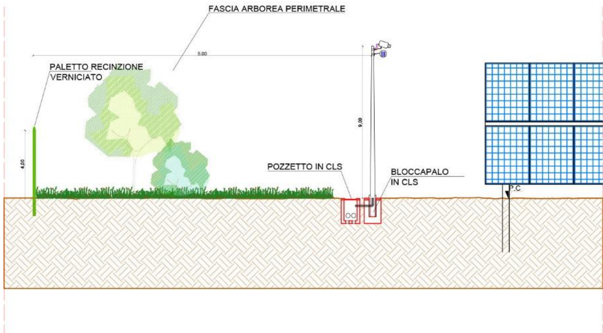
Figura 56: Dettaglio tipo recinzione ed illuminazione
