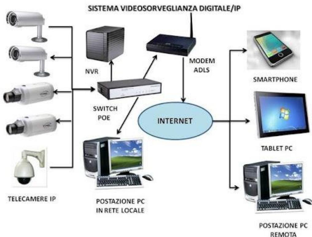
Come dai disegni di progetto e prevista la realizzazione di una sala Controllo in grado di visualizzare le immagini del Sistema di Videosorveglianza. La suddetta sala disporrà delle apparecchiature necessarie a garantire la visualizzazione dei flussi Video e l'accesso alle registrazioni.
