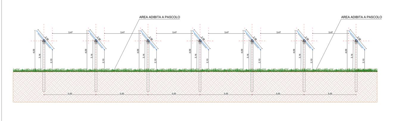
DETTAGLIO SEZIONE LONGITUDINALE STRUTTURA - SCALA 1:100
