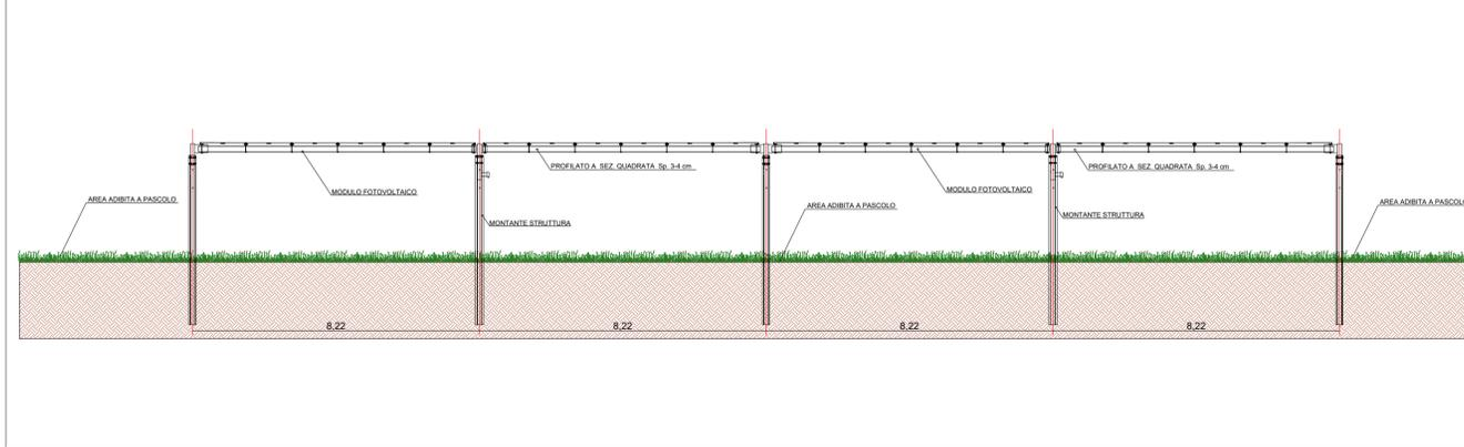
DETTAGLIO TRASVERSALE STRUTTURA - SCALA 1:100
