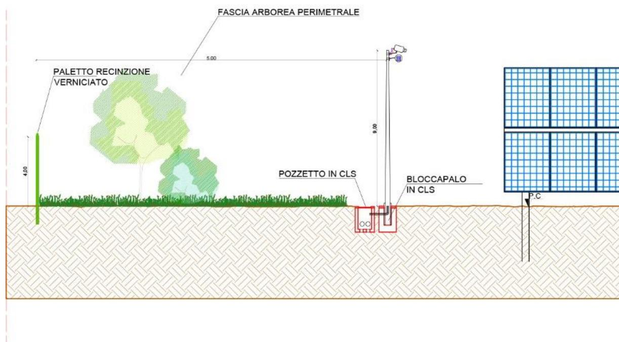
Figura 41: Dettaglio tipo recinzione ed illuminazione
