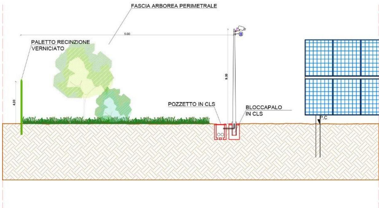
**Figura 26: Dettaglio tipo recinzione ed illuminazione**
