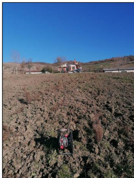
**Fig.05: Prove geofisiche MASW eseguite nell'area prevista per l'installazione dei pannelli fotovoltaici**
