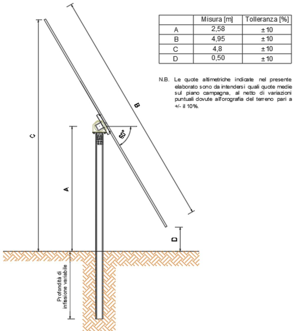
Figura 16 – Vista laterale moduli fotovoltaici montati su strutture ad inseguimento (stralcio dell'elaborato PD-G.2.3.2)
