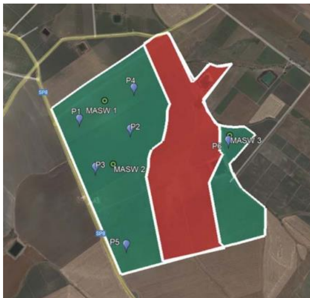
Figura 10 – Planimetria con individuazione dei sondaggi di progetto
