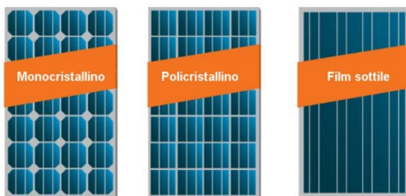
Figura 1 - Tecnologie di pannelli fotovoltaici
