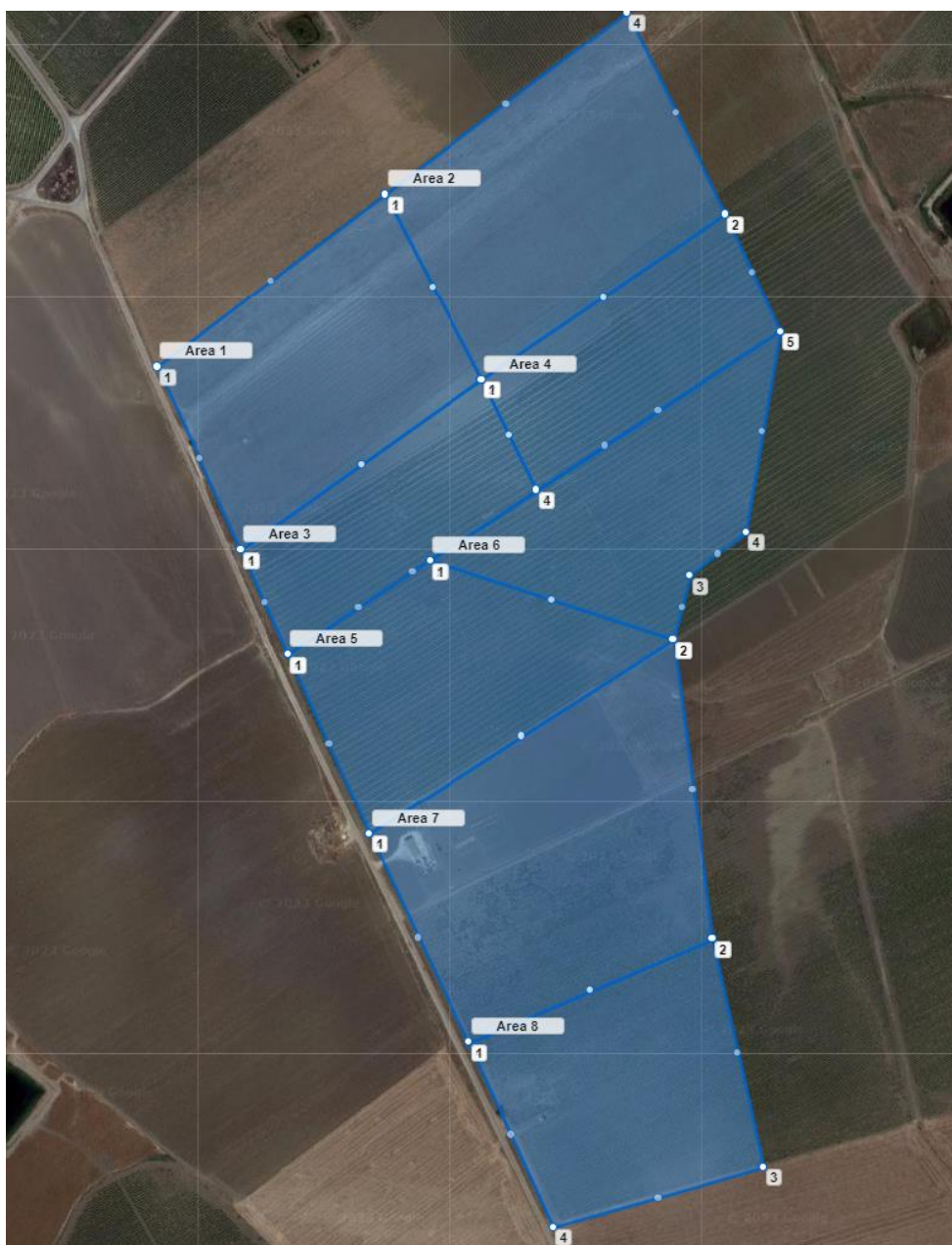
Suddivisione in “Sottocampi” dell’impianto fotovoltaico
