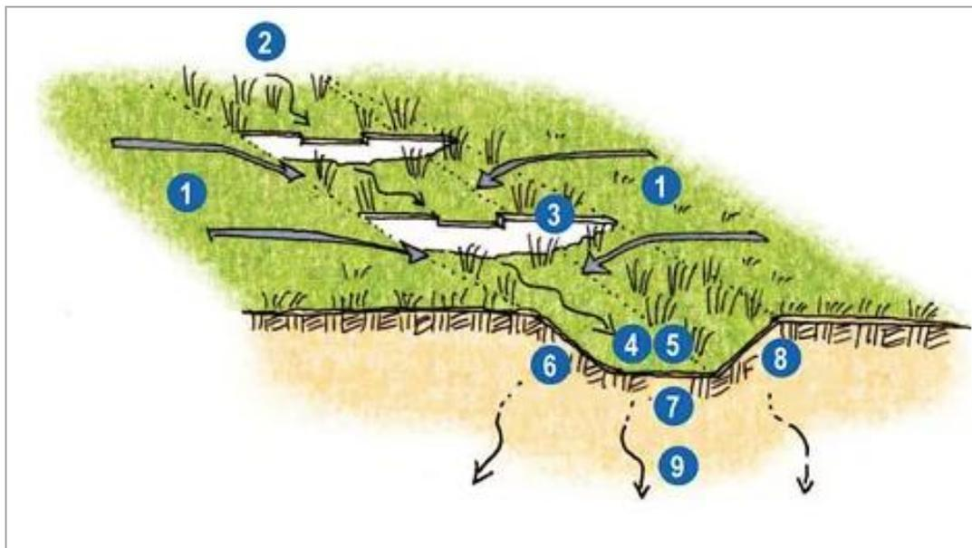
Figura 26- Disegno schematico degli swales.
