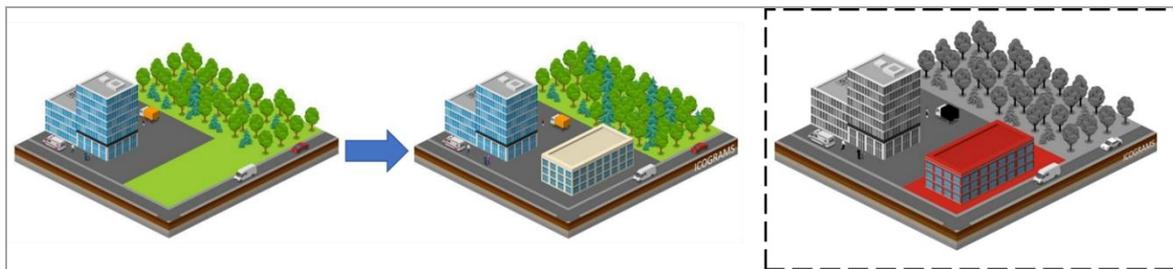
Figura 24- Esempio, secondo la Norma (nel caso di una trasformazione di suolo per costruzione edilizia) del calcolo delle superfici rispetto alle quali commisurare l'invarianza idraulica.
