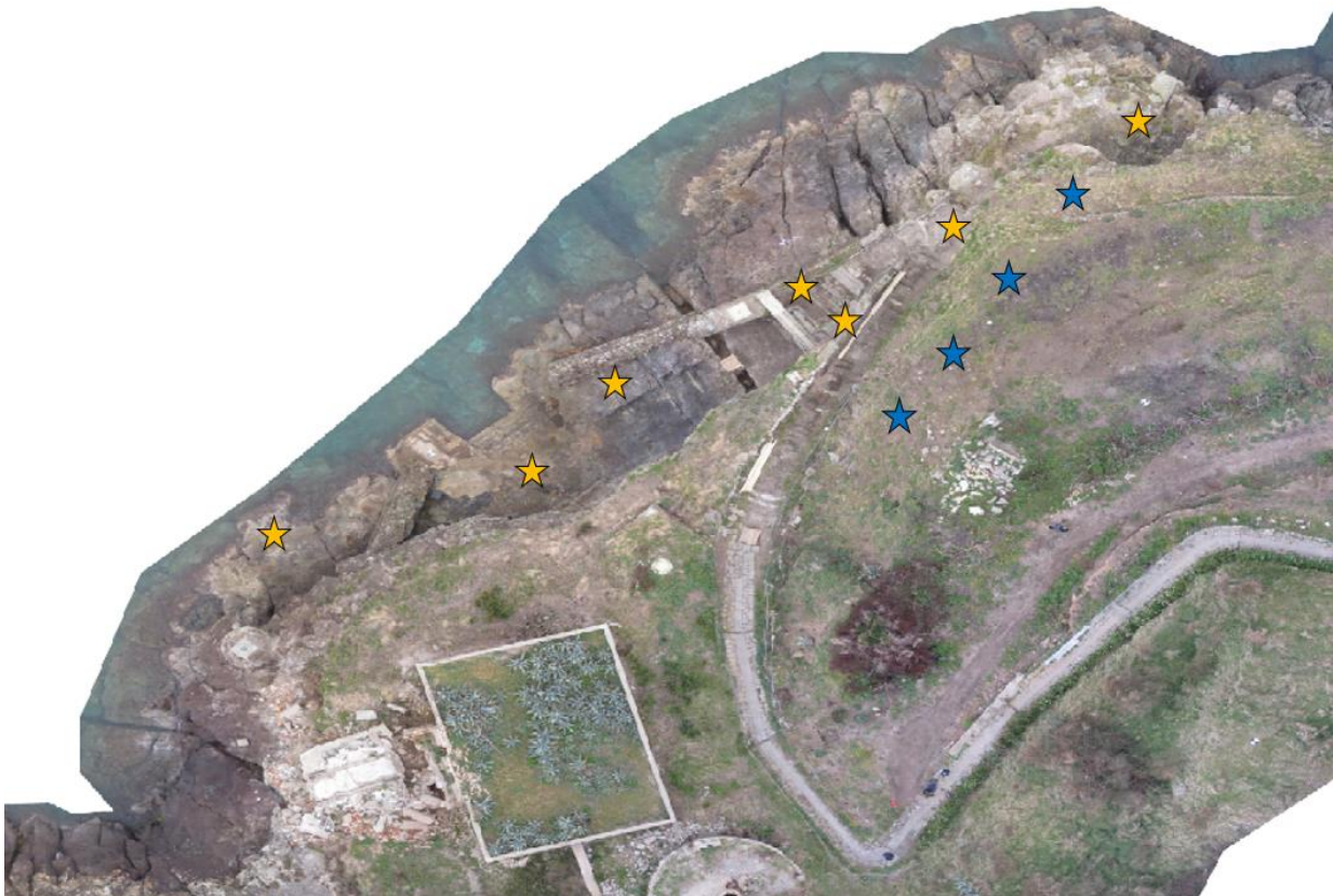
Figura 14 - Localizzazione dei punti di scansione presso lo scalo Marinella (in giallo i punti di acquisizione all'esterno, in blu quelli interni alla grotta).
