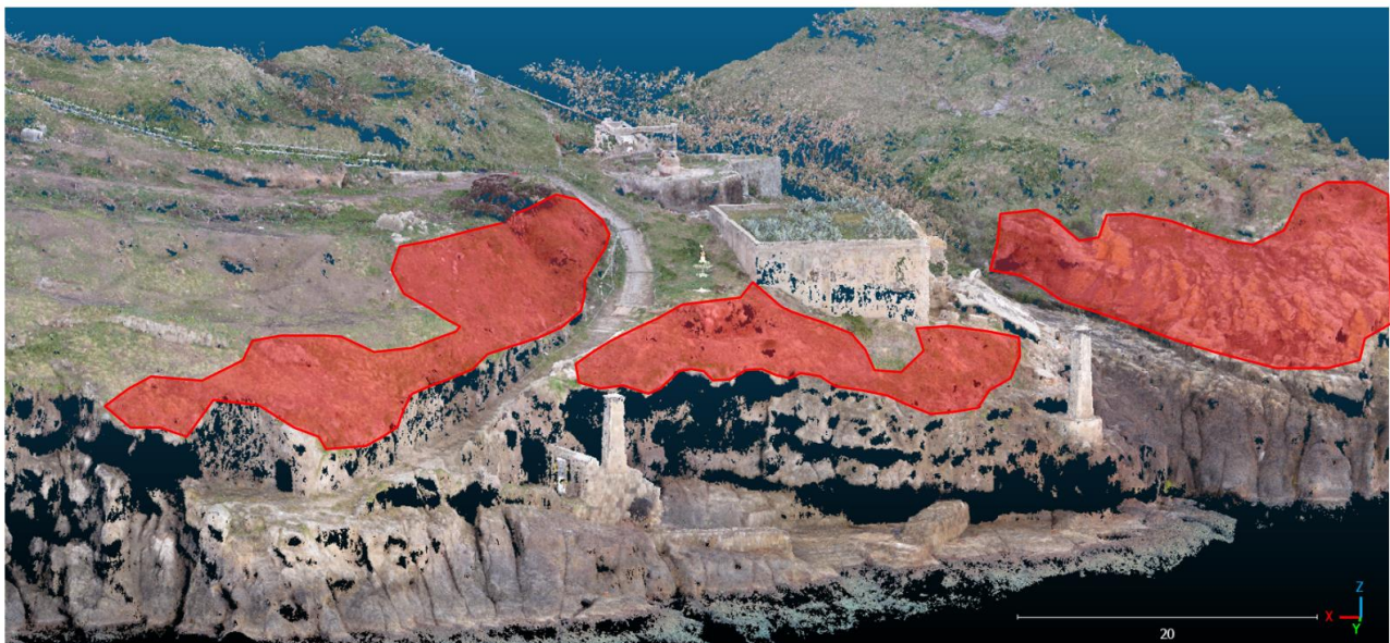
Figura 115 - Scalo Marinella: aree soggette ad erosione idrica diffusa severa.
