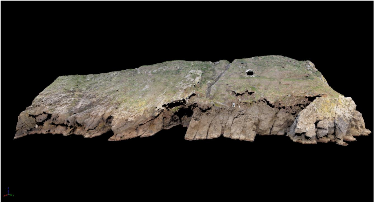
Figura 32 - Nuvola di punti relativa allo Scalo 4 utilizzata per la ricerca dei piani di discontinuità.
