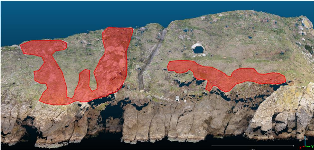
Figura 119 - Scalo n.4: aree soggette ad erosione idrica diffusa severa.
