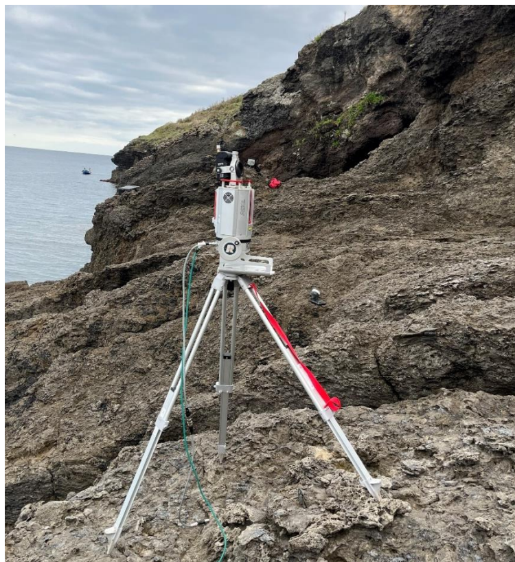
Figura 16 - Laser scanner Riegl VZ-1000 mentre acquisisce dal punto di scansione.
