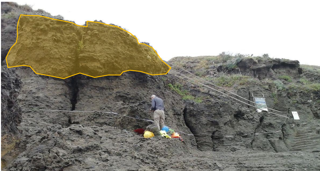
Figura 121 - Scalo n.4: affioramento aggettante della Formazione SS2 potenzialmente soggetto a distacco di elementi litoidi per alterazione del litotipo.
