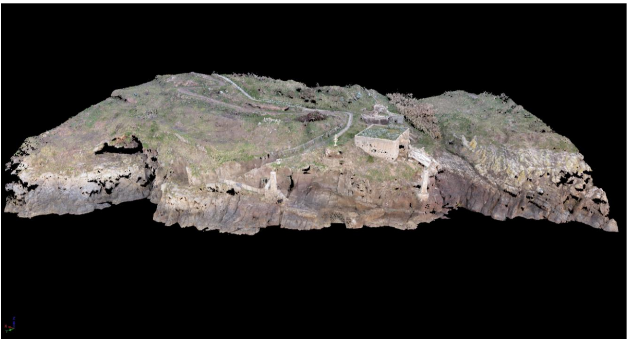
Figura 33 - Nuvola di punti relativa allo scalo Marinella utilizzata per la ricerca dei piani di discontinuità.
