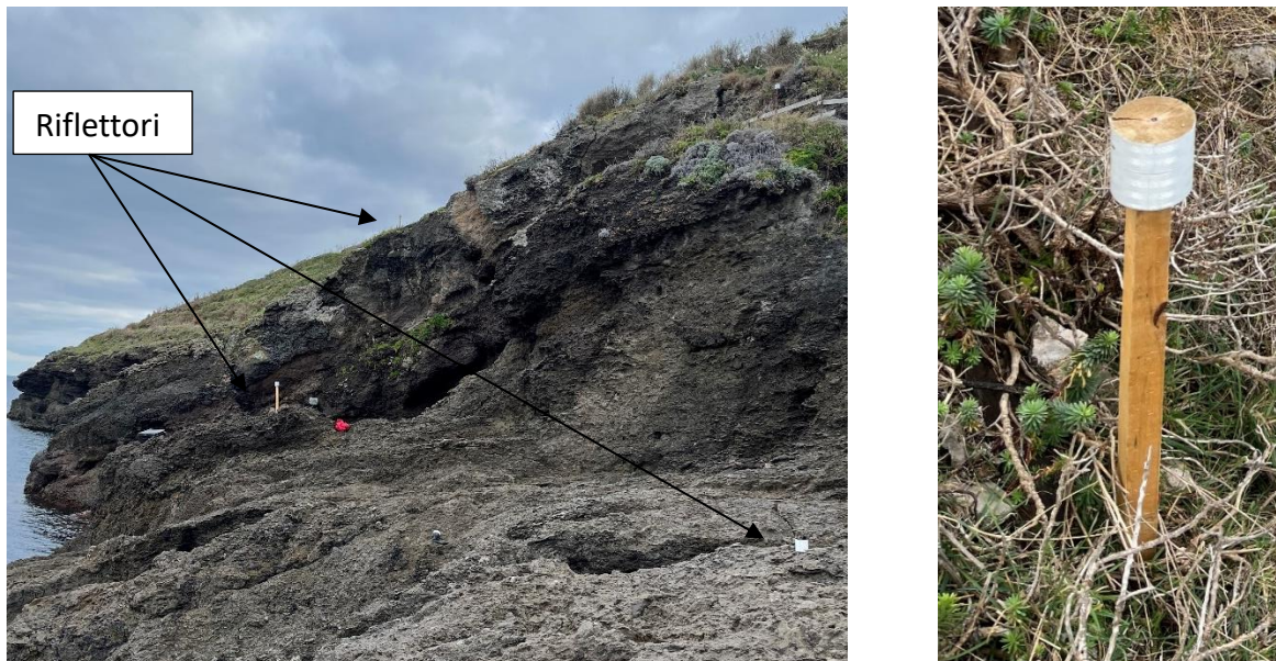
Figura 17 - A sinistra foto del posizionamento di alcuni riflettori presso lo Scalo n.4; a destra un riflettore in dettaglio.
