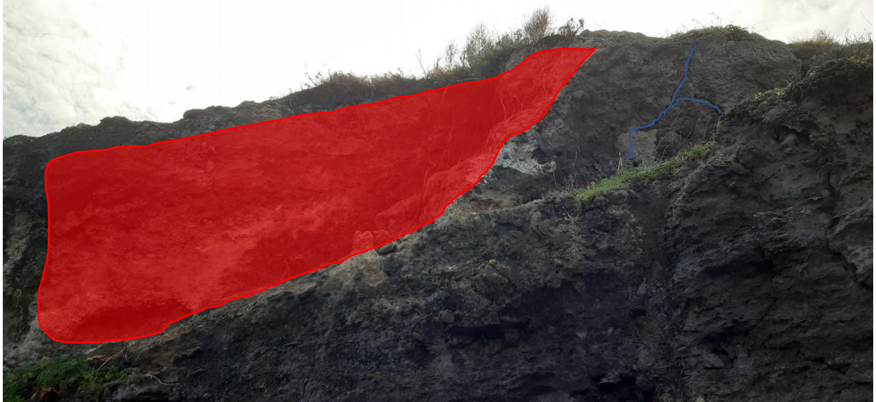
Foto 4: Ante opera - Vista B con evidenza delle fratture (blu) e della superficie di un precedente distacco (rosso)
