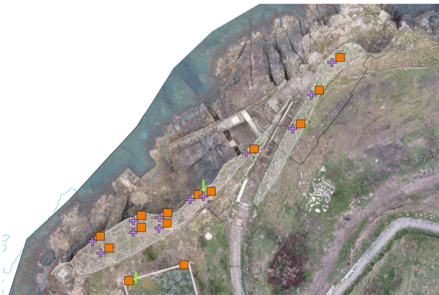
Figura 47. Planimetria punti e strumenti di monitoraggio scalo Marinella
