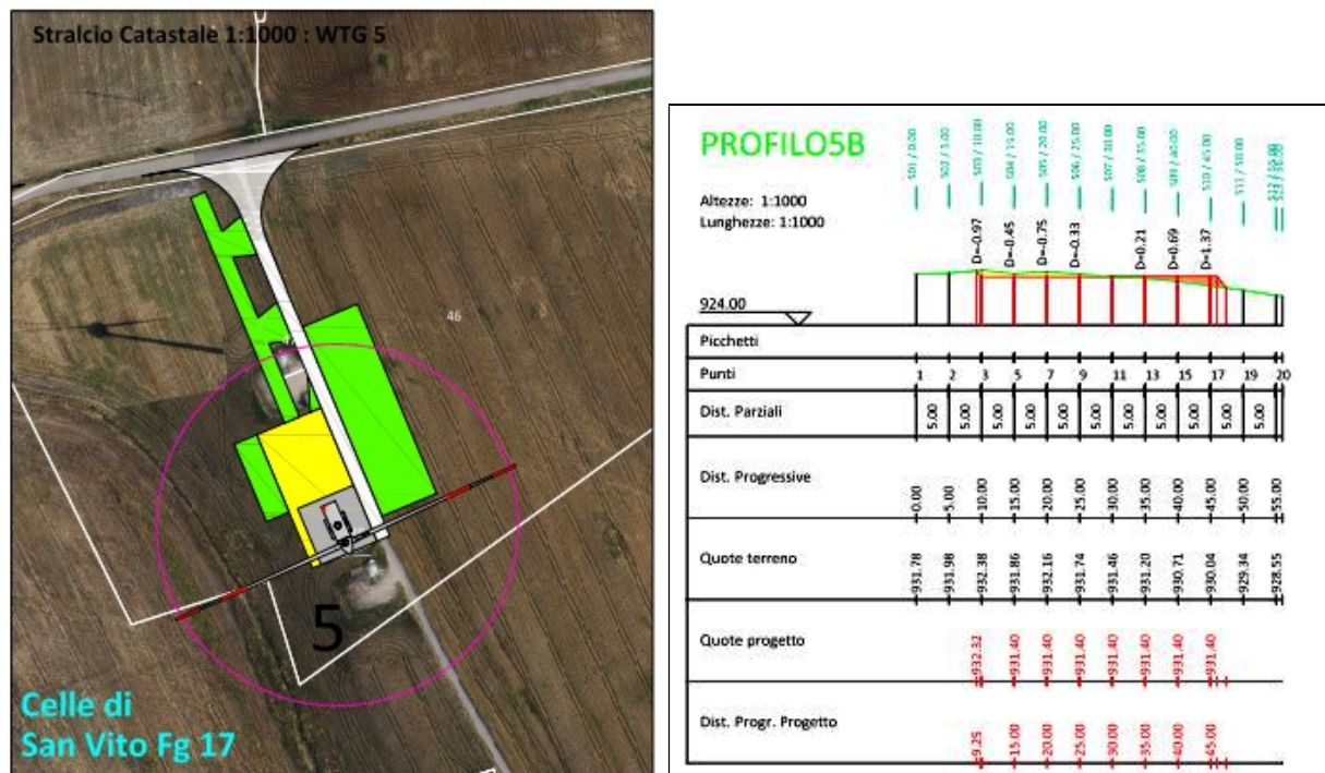
Fig. 7e: Posizione WTG5 - Profilo terreno WTG5
