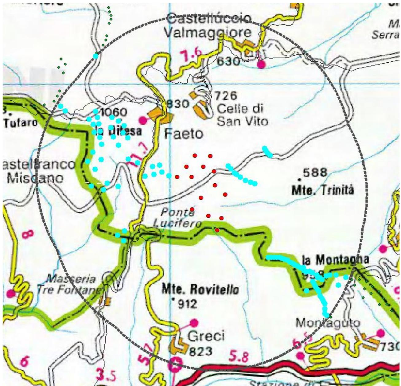
*Figura 11 – Area di valutazione cumulativo con la localizzazione degli aerogeneratori in progetto (in rosso), di quelli in esercizio (in ciano)*
