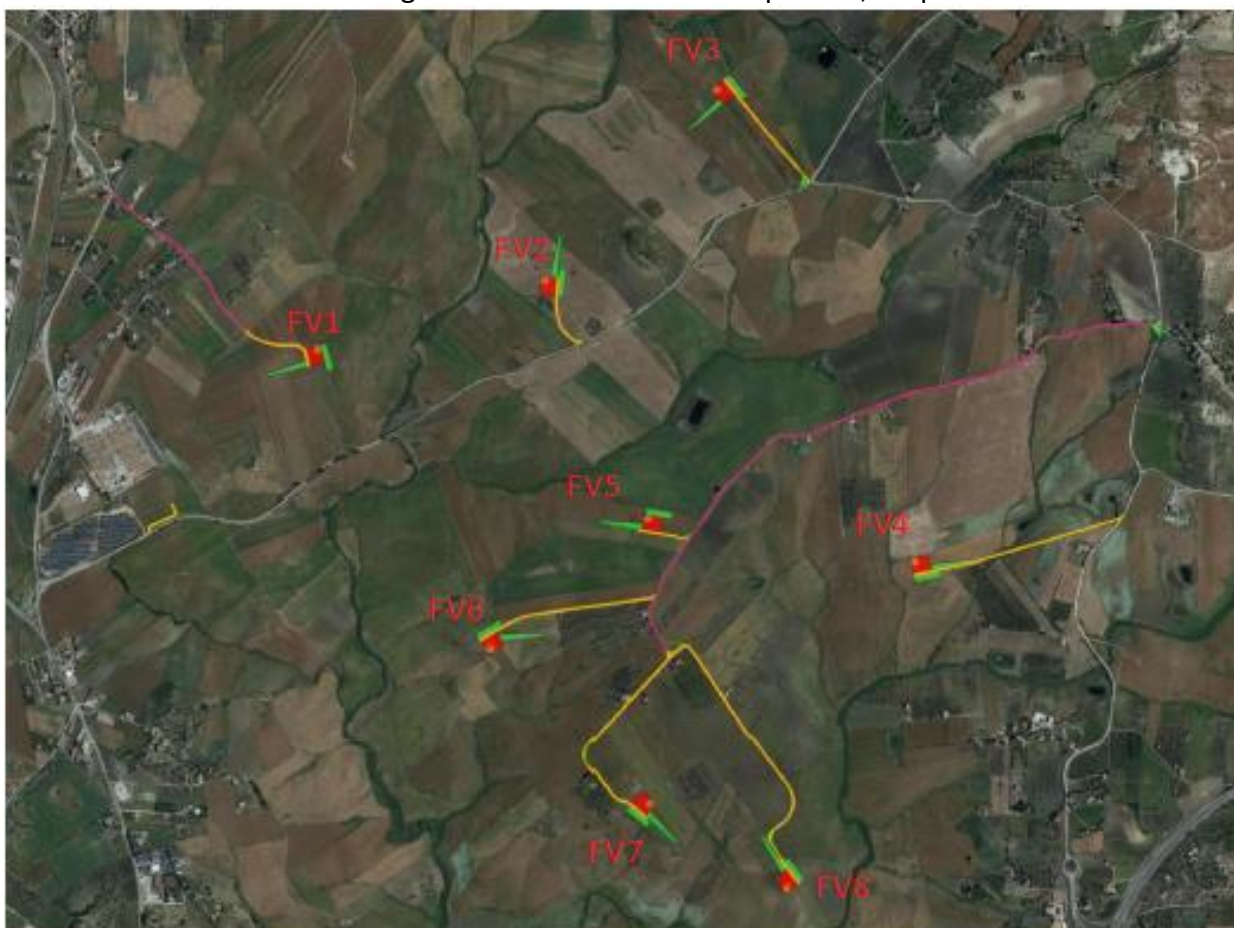
Figura 1 – Stralcio elaborato da 21007 FVR_PD_R_18_00 - Relazione paesaggistica, con evidenziate le strade di accesso all'impianto eolico di nuova realizzazione (in giallo) e le strade esistenti da adattare (in viola)
