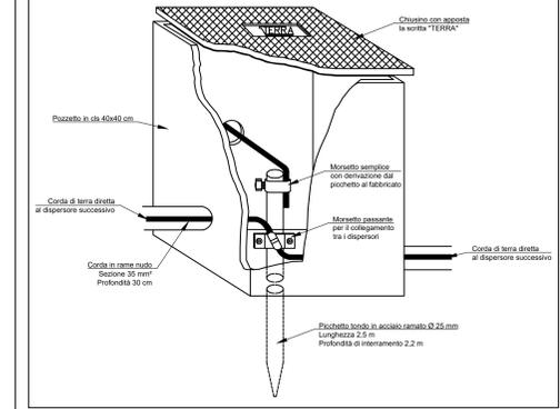
**PARTICOLARE COLLEGAMENTO CONDUTTORE DI TERRA E DISPENSORE DI FATTO** - Non in scala
