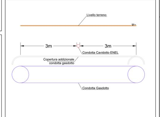
SEZIONE ATTRAVERSAMENTO GASDOTTO DELLE LINEE BT DELL'IMPIANTO - Scala 1:20
