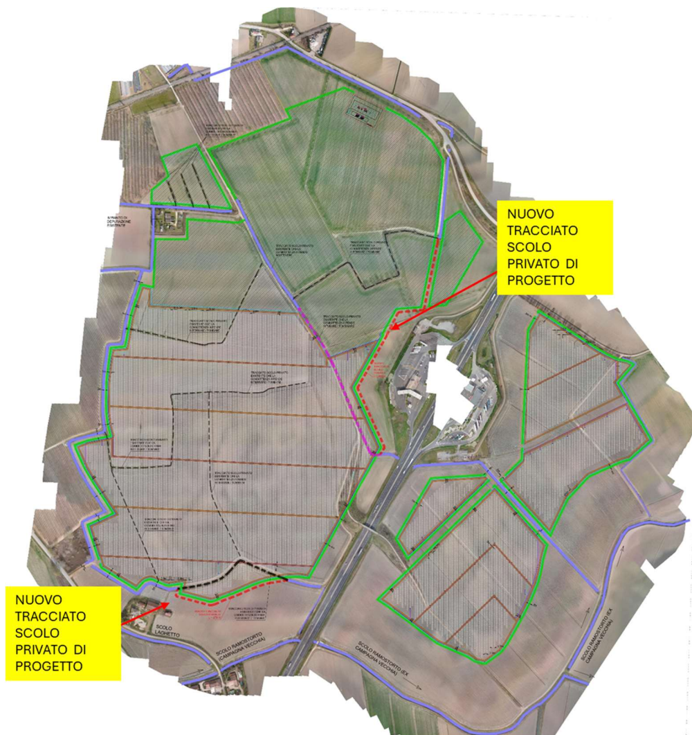
Figura 58 Estratto planimetria di progetto con tracciamento nuovi scoli di progetto
