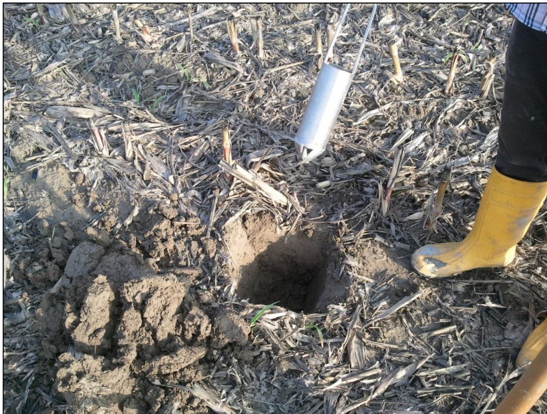
Esempio campionamenti superficiali con campionatore in acciaio inox
