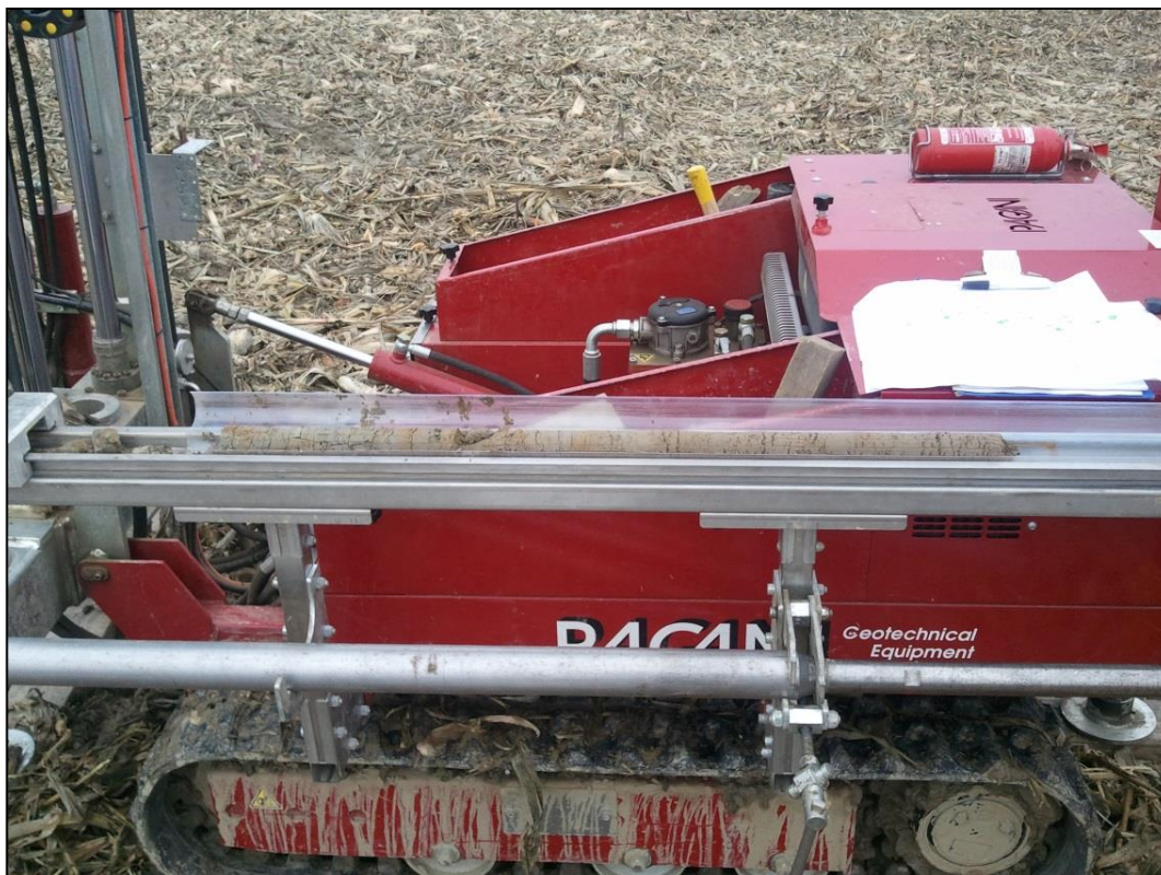
taglio fustella in pvc e prelievo terreno
