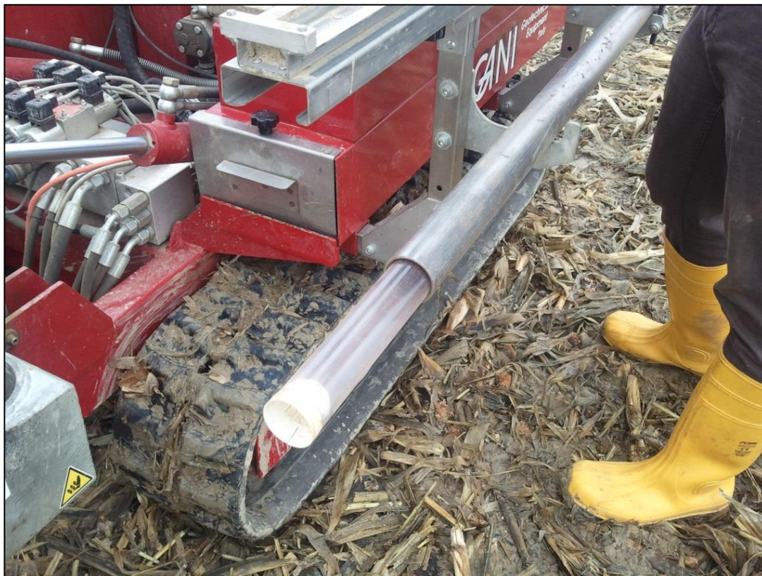
Esempio particolare fustella e campionatore
