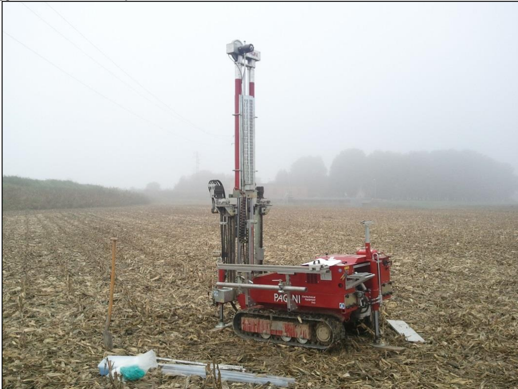
Esempio esecuzione sondaggio a carotaggio continuo
