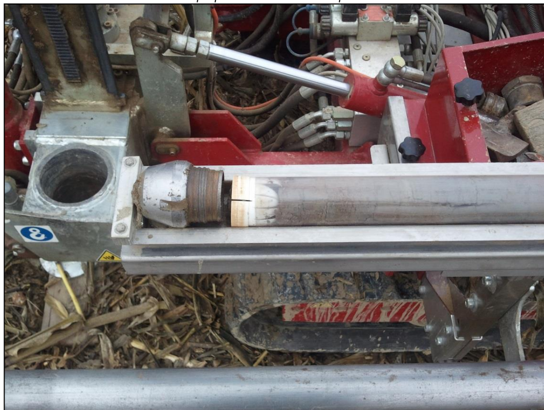
Esempio estrazione fustella con terreno
