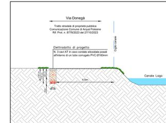
SEZIONE H-H - ATTRAVERSAMENTO CANALE CAMPESTRIN - Scala 1:100
