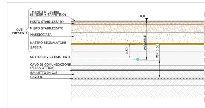
**SEZIONE TIPO ATTRAVERSAMENTO SOTTOSERVIZI GAS - RETE IDRICA - TELECOM - CAVI ELETTRICI**
