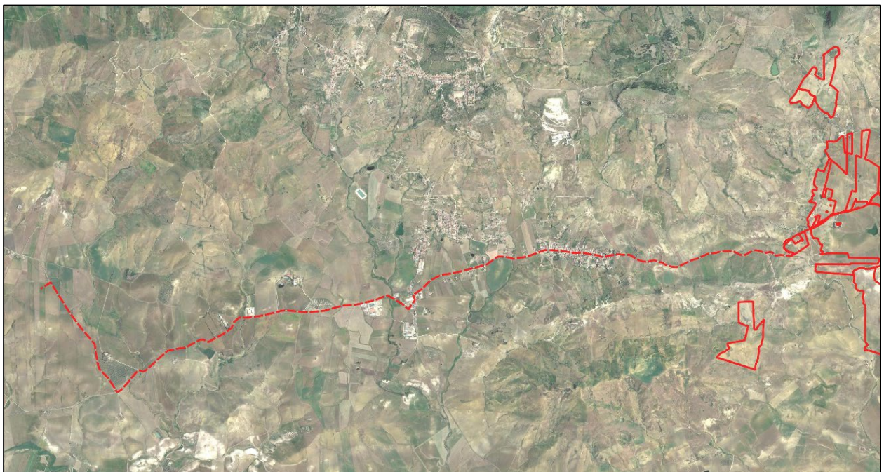
Figura 4. Localizzazione tracciato cavidotto su ortofoto
