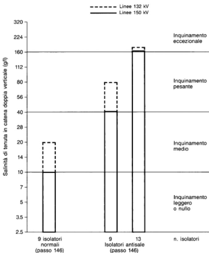
Per le linee che attraversano zone prive di inquinamento atmosferico è previsto l'impiego di catene (di sospensione o di amarro) composto da 9 elementi di tipo "normale".
