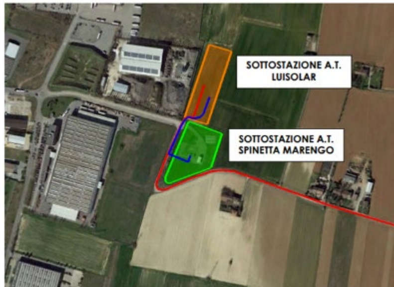
Figura 3 Cavidotto AT (in blu) e cavidotto MT (in rosso) e SSEU di trasformazione (in arancione), SE Enel (in verde)
