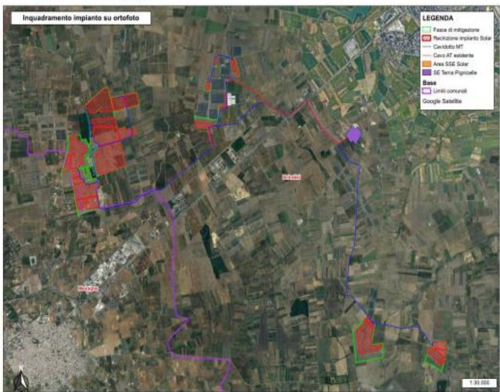
**Inquadramento generale su Ortofoto - Aree Impianto e cavidotto MT 30 kV di connessione alla RTN**
