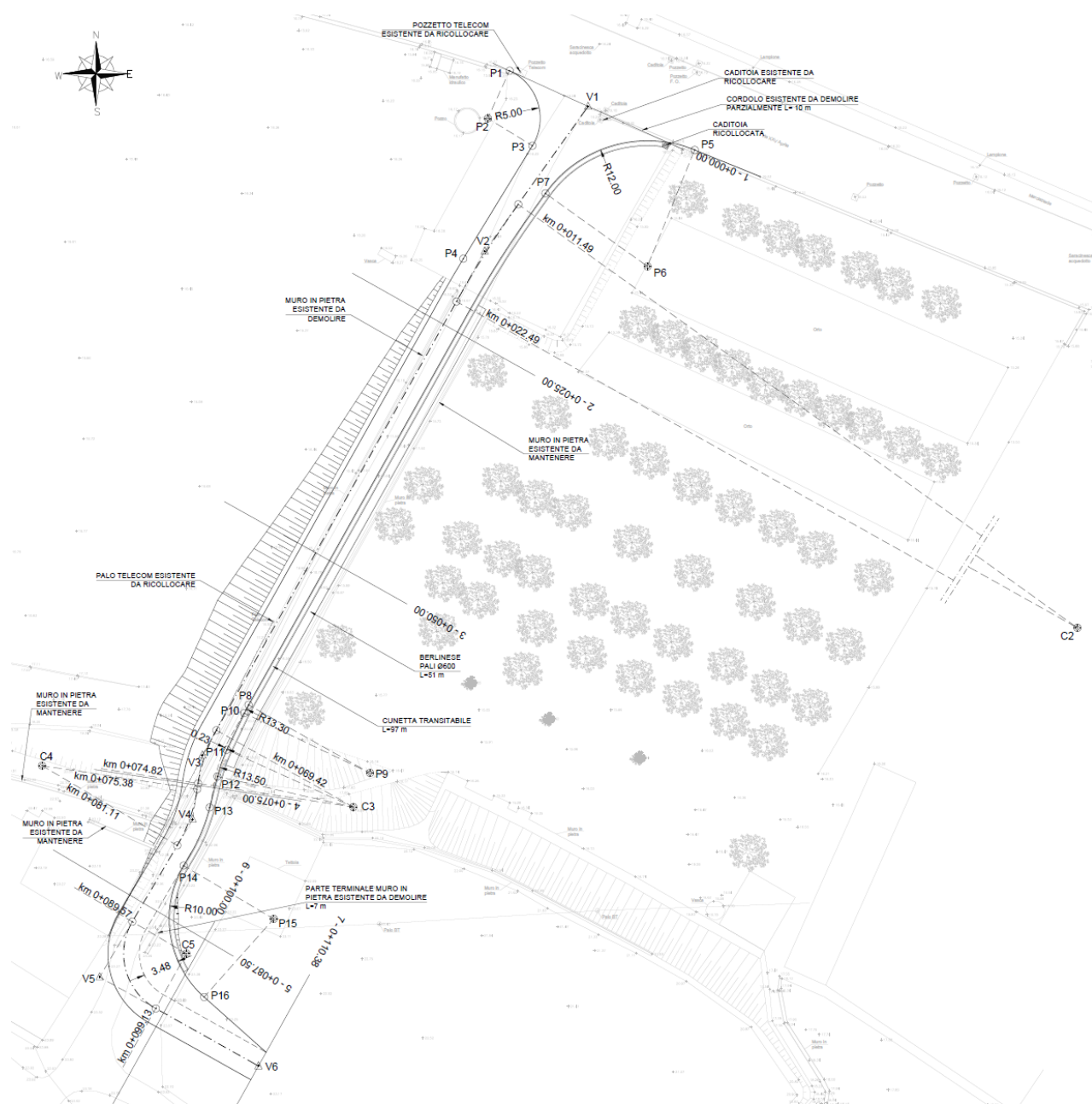
Figura 3: Tracciato della nuova strada permanente (ID7B)
