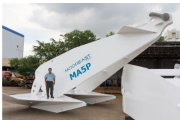
Figura 5-4 Configurazione tipica di ancore a trascinamento (drag embedded anchor)
