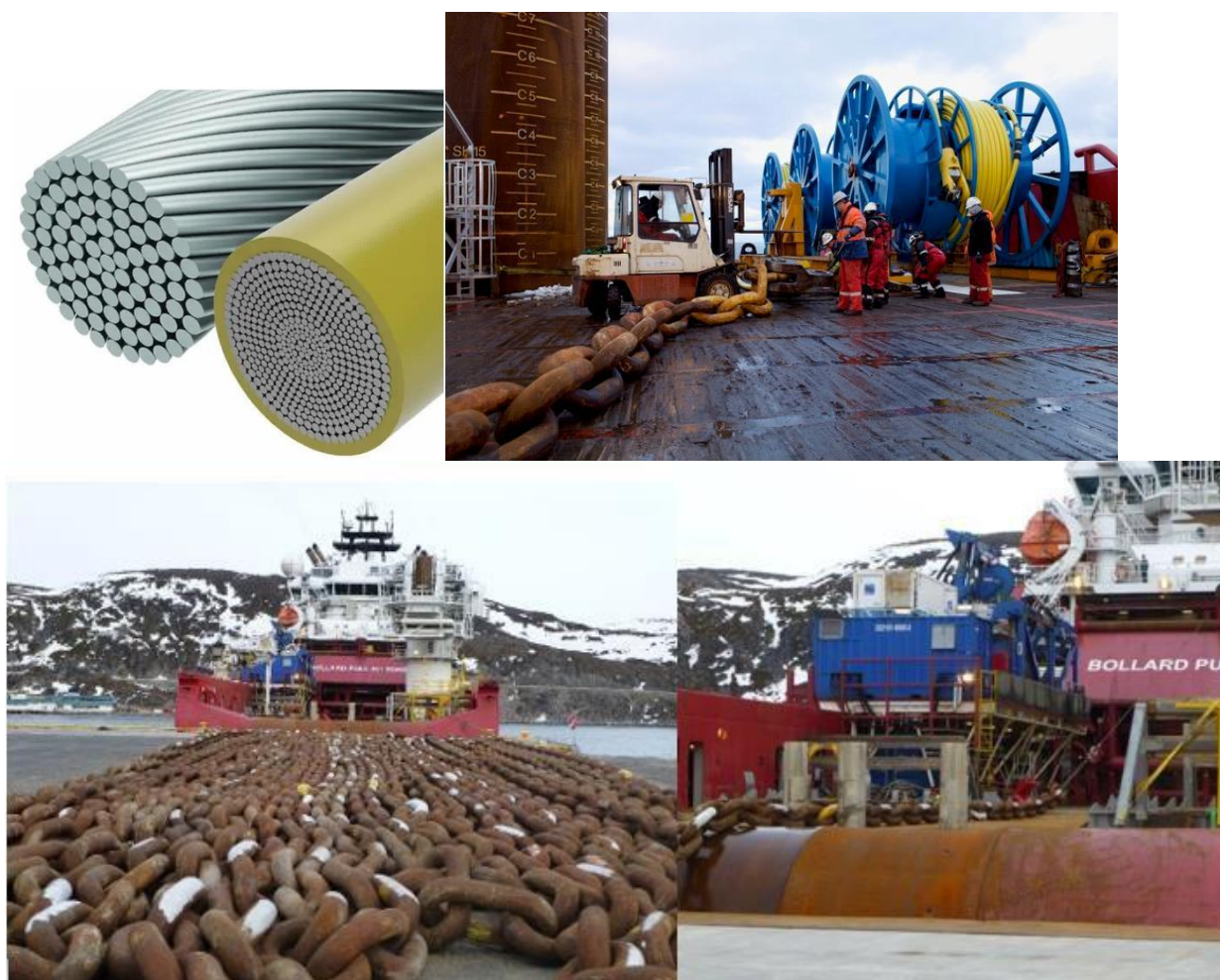
Figura 5-6 Tipici elementi di ormeggio stivati a bordo di una nave d'installazione. (courtesy of Aker)
