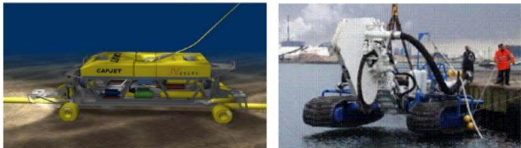
Figura 9-5 – Esempio di mezzi Sottomarini per Interramento di Cavi
