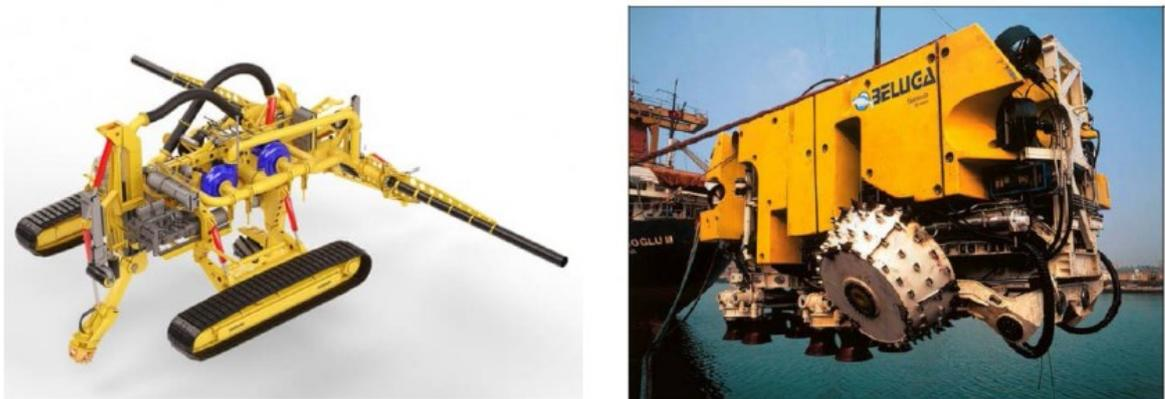
**Figura 4.17: Esempio di Mezzo Sottomarino Tradizionale per Operazione di Interramento della Condotta con Post trenching”**
