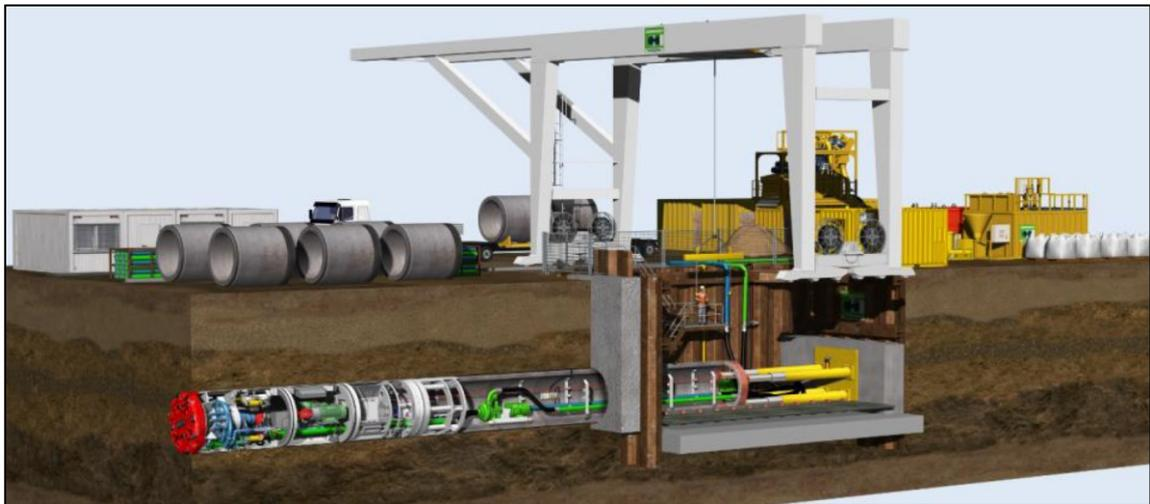
**Figura 4.23: Pozzo di lancio di un MT e stazione di spinta principale**
