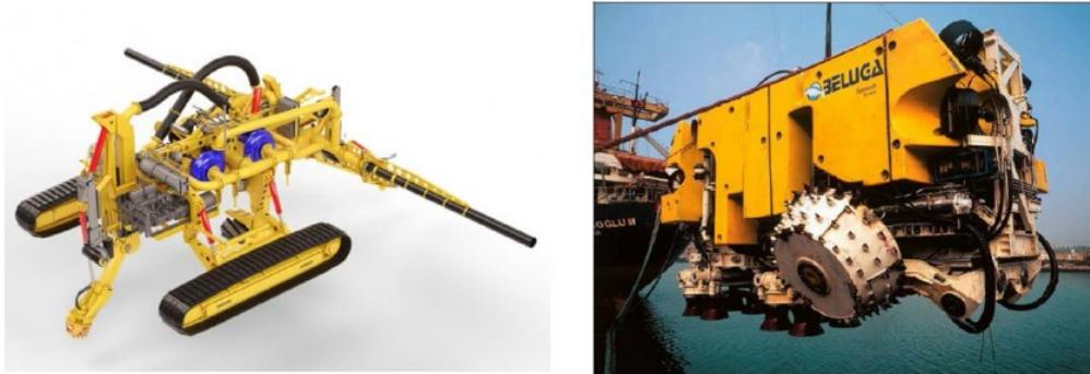
**Figura 2.18: Esempio di Mezzo Sottomarino Tradizionale per Operazione di Interramento della Condotta con Post trenching”**
