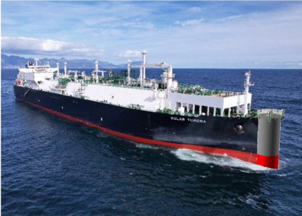
**Figura 2.37: FSRU Golar Tundra con turret buoy**
