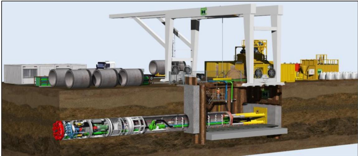
**Figura 2.24: Pozzo di lancio di un MT e stazione di spinta principale**
