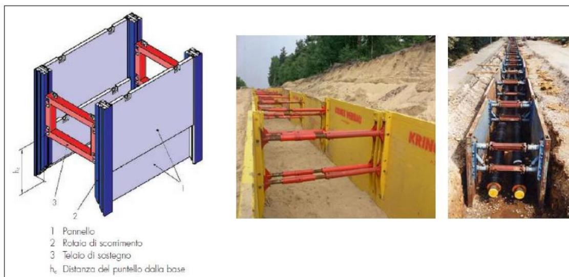
**Figura 2.21: Opere provvisorie - sbadacchiature con legname e sistemi di puntellazione per scavi**
