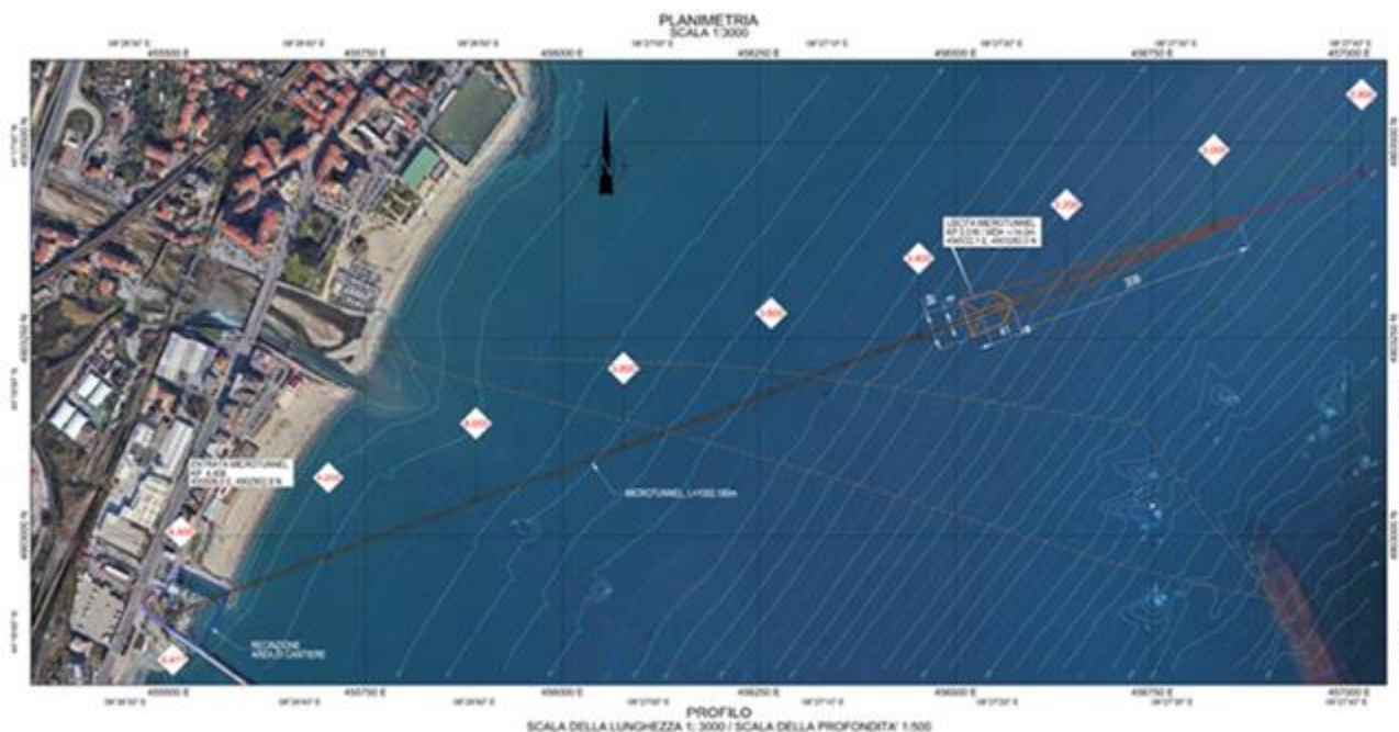
Figura 3.7: Microtunnel di approdo costiero
