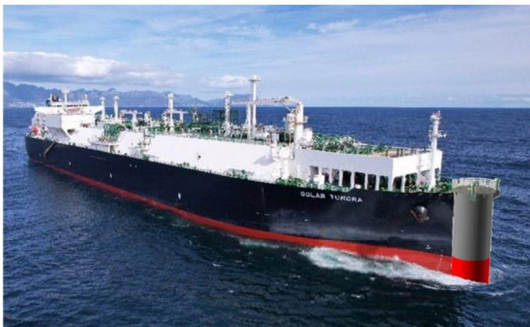
**Figura 4.5:** FSRU Golar Tundra con *turret buoy*
