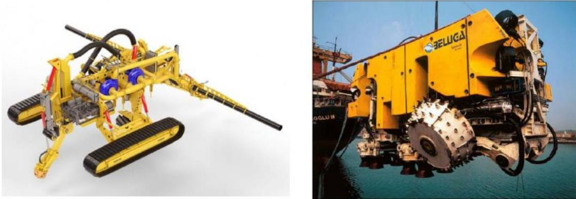
**Figura 8.6:** Esempio di Mezzo Sottomarino Tradizionale per Operazione di Interramento della Condotta con Post trenching
