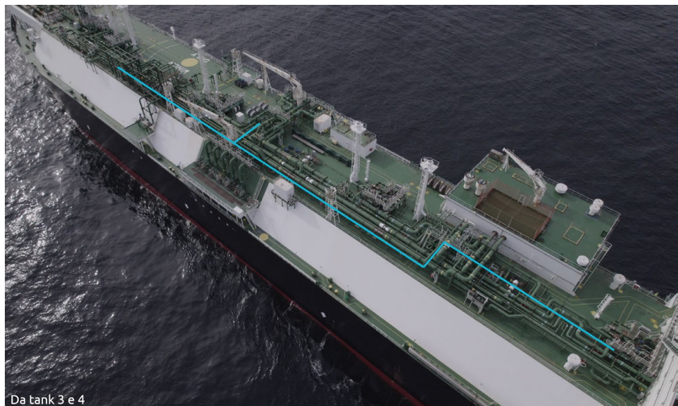
Figura 17 - Fotografia FSRU Tundra – Linee di mandata pompe LNG Feed e collettore GNL alimentazione sezione rigassificazione (da serbatoi 3 e 4)
