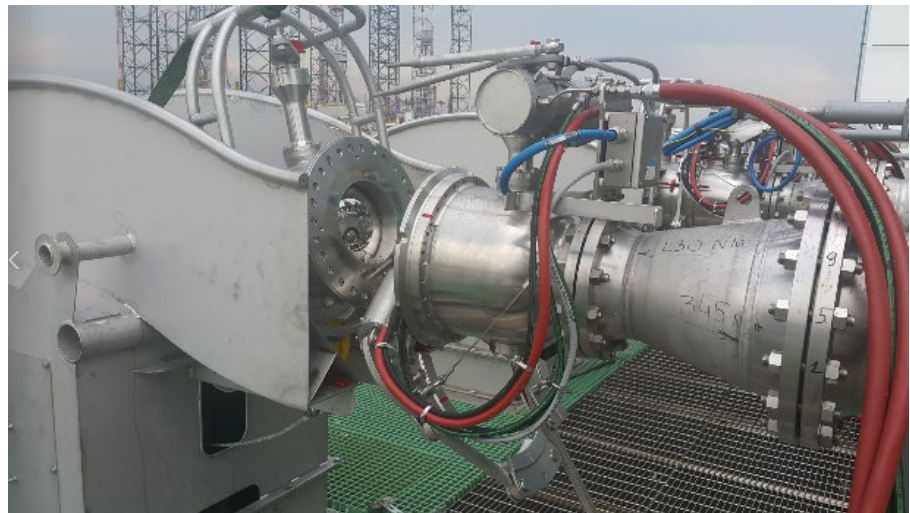
Figura 47 – Dettaglio fotografico accoppiamento manichette
