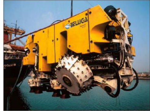
Figura 12: Esempio di Mezzo Sottomarino Tradizionale per Operazione di Interramento della Condotta con Post Trenching
