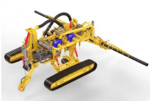
Figura 12: Esempio di Mezzo Sottomarino Tradizionale per Operazione di Interramento della Condotta con Post Trenching
