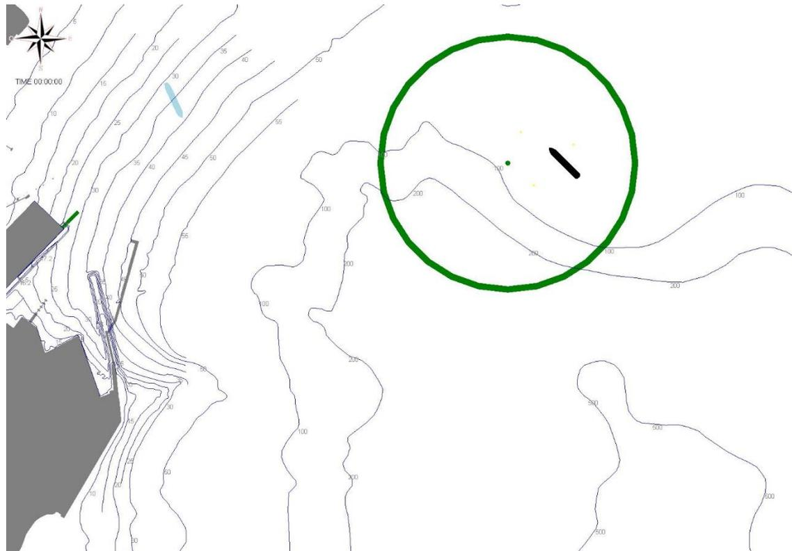
Fig. 3-3 Zona d'ancoraggio Charlie – Layout 2D di progetto rappresentato nel simulatore WHALE, con andamento dei fondali e ingombro presente nell'area di manovra.
