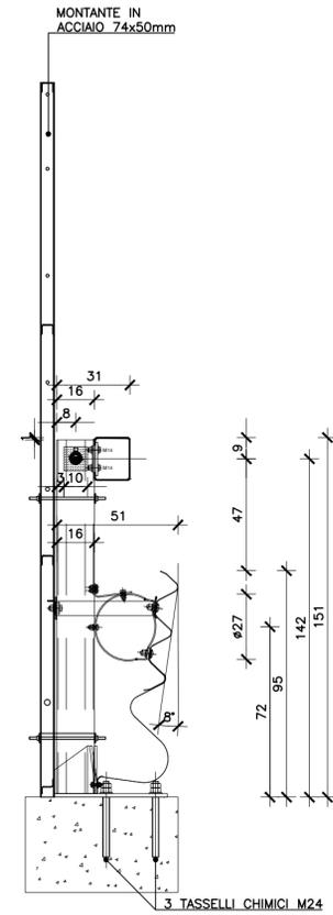
IL SUBMONTANTE SUPERIORE IN ACCIAIO 74x50mm È PRELIEVATO IN UNO DEI PUNTI DI SOSTEGNO DELLA BARRIERA E CONNESSIONATA IN CORONA CON I PANNELLI IN LAMIERA MICROFORATA. L'APPROPRIO COMPLETO DELLA PIANTINA.
