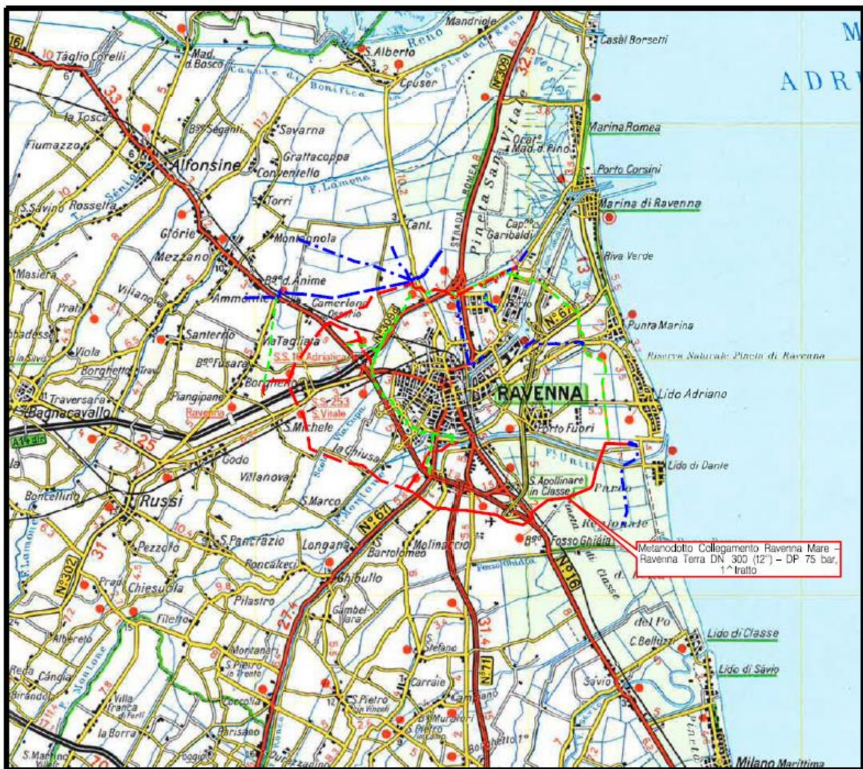
Figura 2/1 – Stralcio Atlante 1:200.000 con localizzazione delle opere (in rosso metanodotto In progetto, in verde metanodotto In dismissione, in blu metanodotti esistenti)
