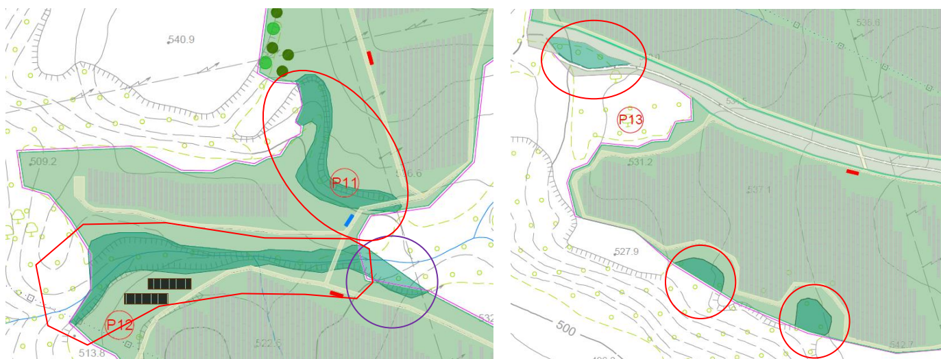
Fig.13 - Stralci di dettaglio delle fasce boscate vincolate interferite (a sinistra in viola) o intercluse (a sinistra e a destra in rosso) all'interno della recinzione di progetto, nel campo in Località Morello (cfr elab. 41_DR_18 Layout generale impianto - C.02)
