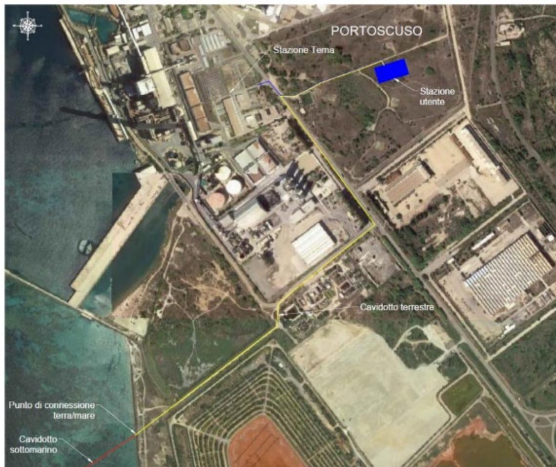
Figura 12: Vista aerea del percorso del cavo di terra
