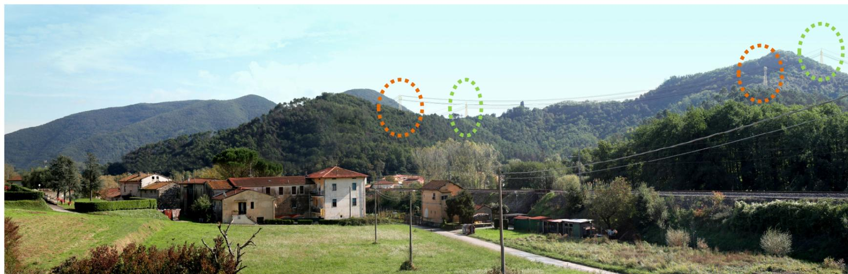
**Foto 10:** Stato di progetto. In arancione sono indicate le posizioni dei sostegno n.7 e n. 8 della linea 380 kV tratto sud in progetto. In verde sono indicate le posizioni dei sostegni n. 9 e n. 10 della linea 132 kv DT in progetto.
