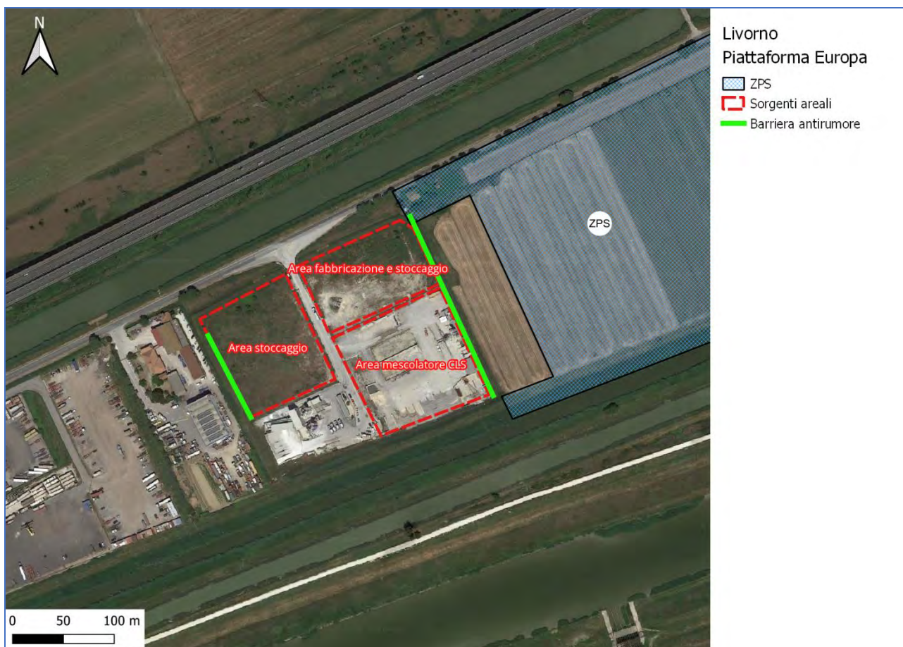
Figura 14: Elementi “barriera antirumore” inseriti nel modello acustico lungo il perimetro est ed il perimetro ovest delle aree di proprietà della SALES S.p.A. dove verranno fabbricati gli accropodi
